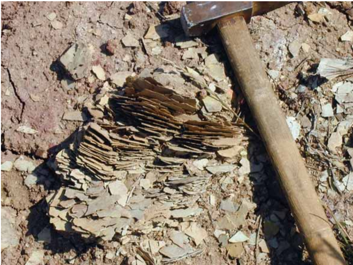
Obr. 4. Jílovce cyprisové a vulkanodetritické série s listkovitou rozpadavostí a s vysokým obsahem Fe. Podkrušnohorská výsypka, s. od Sokolova.
